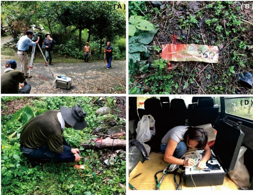
圖 4-2-6 施測過程工作照。(A) 放樣過程工作照；(B) 電極棒置放處之記號。記號上的數字 360 指示此處距地電阻測線西端為 360 公尺遠；(C) 固定電線於電極棒的施作過程工作照；(D) 電線與儀器設備連接之工作照。
