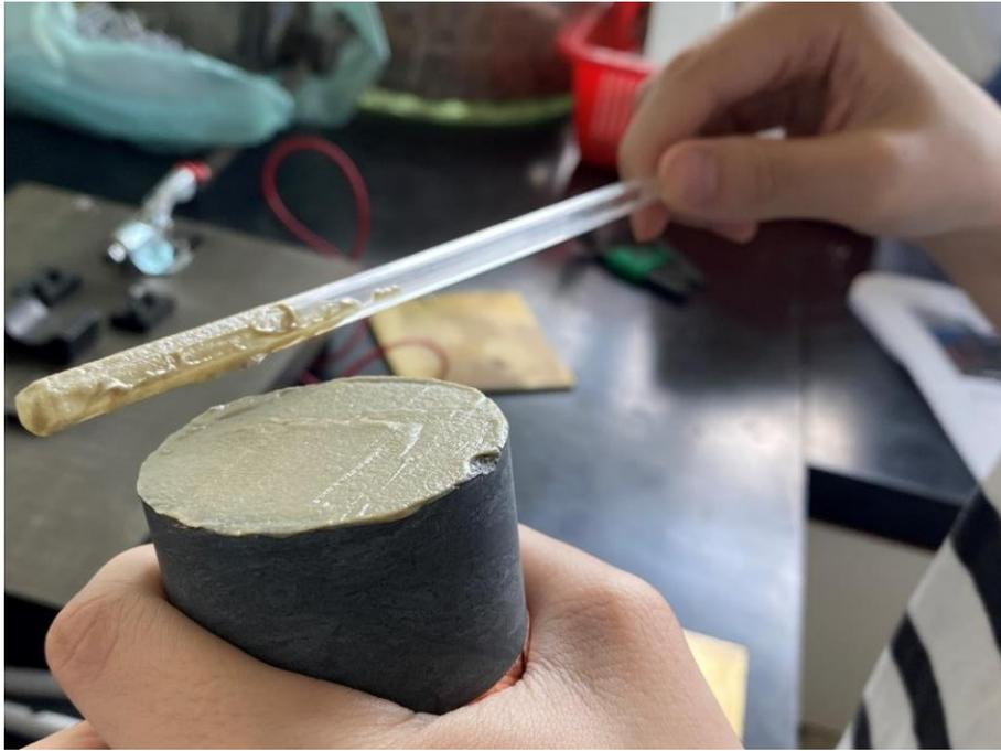
圖 4-3-3 塗抹泥漿後的岩樣。塗抹泥漿在岩樣上下兩面，泥漿不需要太厚，但是需要均勻且平坦。
